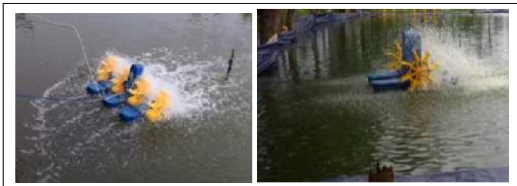
Gambar 2. Kincir air 1 phase dengan daya 250 dan 450 watt
